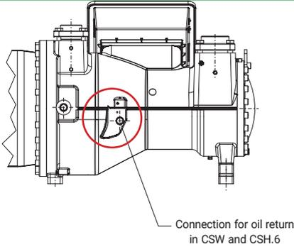
کمپرسورهای سری CS قابلیت کارکرد در سیستم‌هایی با اواپراتور Flooded را داشته و این موضوع در سری های CSH.6 و CSW و CSVW با تعبیه درگاه مخصوص برگشت روغن از اواپراتور Flooded باعث سهولت طراحی در سیستم های Flooded می‌شود.
