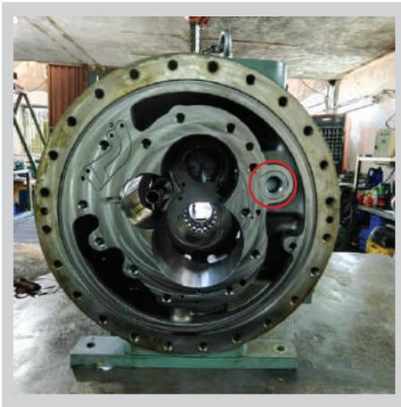
در طراحی بدنه کمپرسور شرکت بیتزر یک شیر اطمینان تعبیه شده است که در صورت افزایش بیش از حد فشار در داخل بدنه کمپرسور بنابه هر دلیلی از آسیب به بدنه کمپرسور جلوگیری می‌کند. در سایر برندها این شیر اطمینان به ندرت دیده می‌شود.
