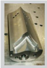
شرکت بیتزر در طراحی اسلایدر کنترل ظرفیت ۶ سوراخ به صورت متقارن تعبیه کرده است که این کار امکان وارد مدار شدن اکونومایزر در تمامی ظرفیت‌ها (۱۰۰-۲۵٪) به صورت پلکانی و پیوسته را فراهم می‌کند.
