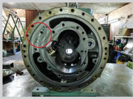
شرکت بیتزر در طراحی بدنه کمپرسور در محل اتصال تمامی اجزا از شیارهایی جهت نصب اورینگ برای آب بندی به بهترین شکل استفاده کرده است.
