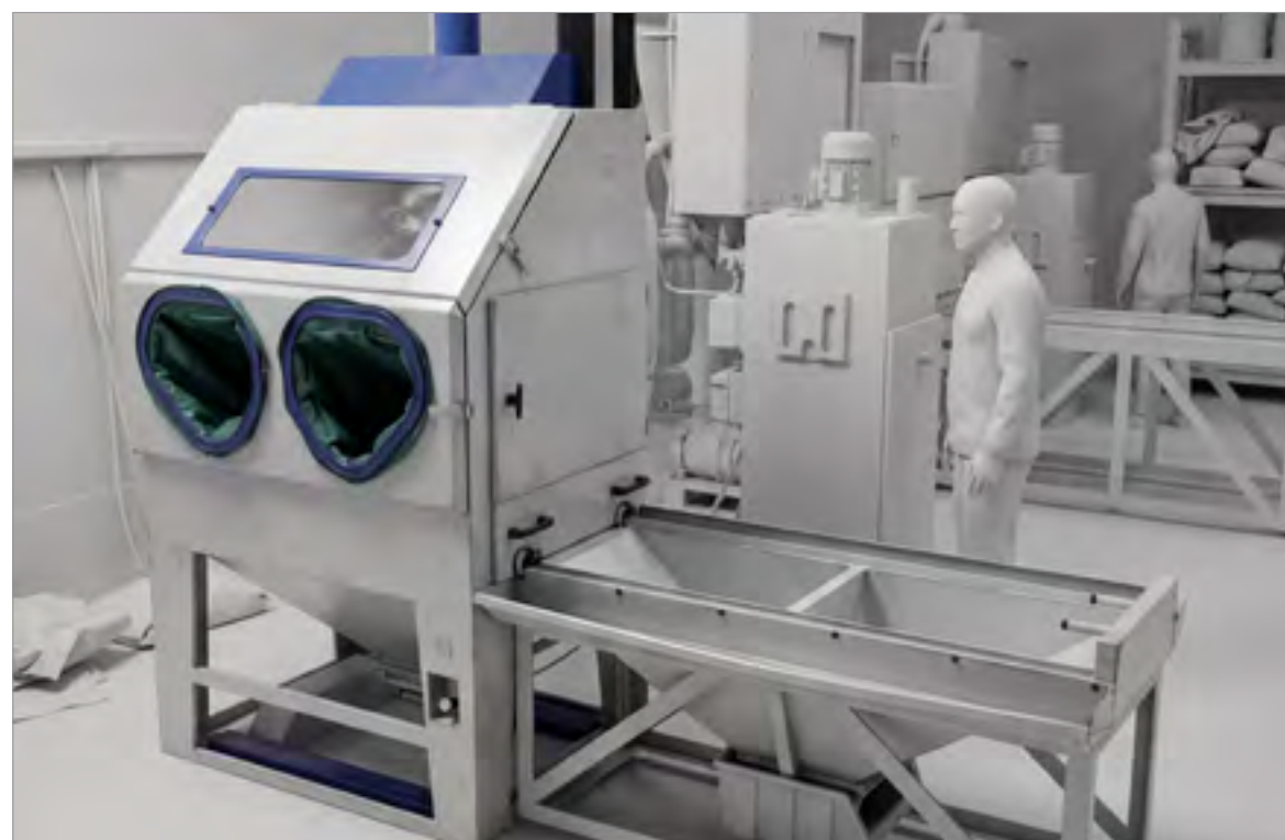
دستگاه سندبلاست SANDBLASTING MACHINE
