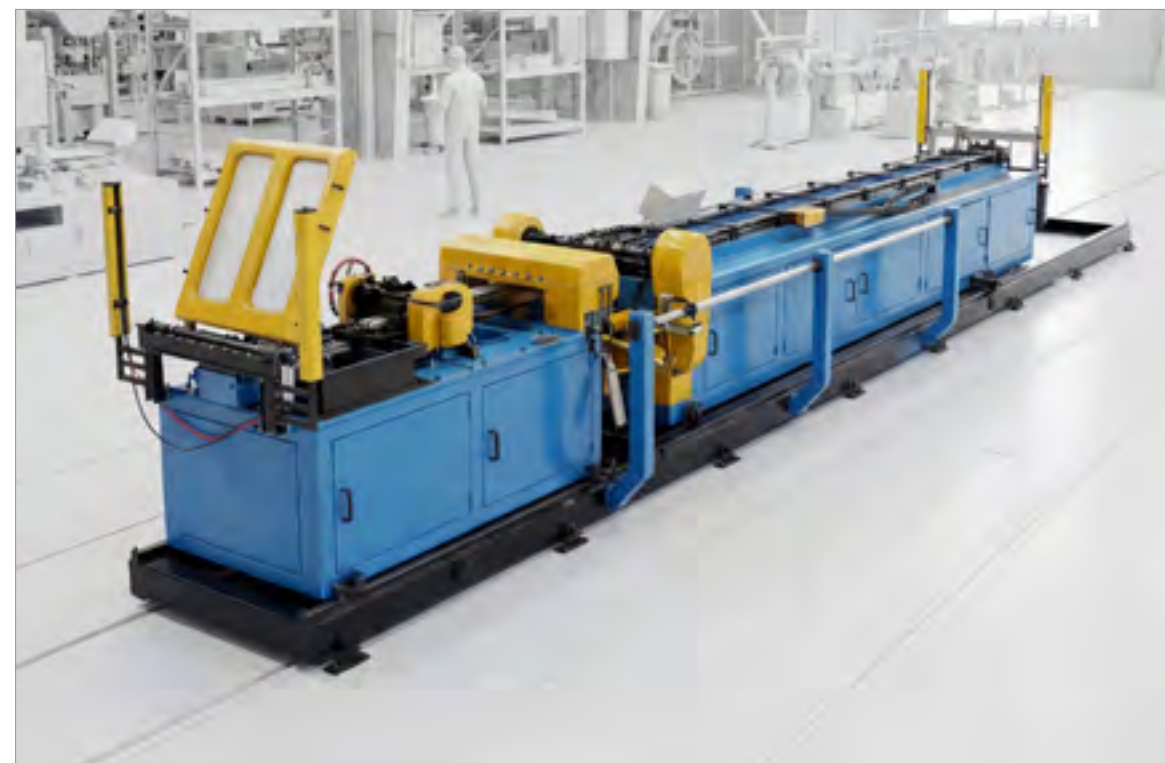
دستگاه خم اتوماتیک هیرپین
