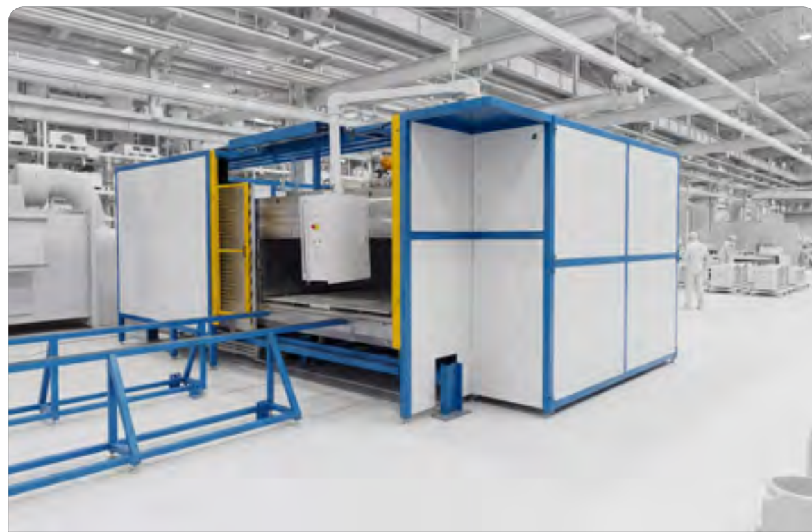
دستگاه تست نشتی هلیوم HELIUM LEAK DETECTOR MACHINE
