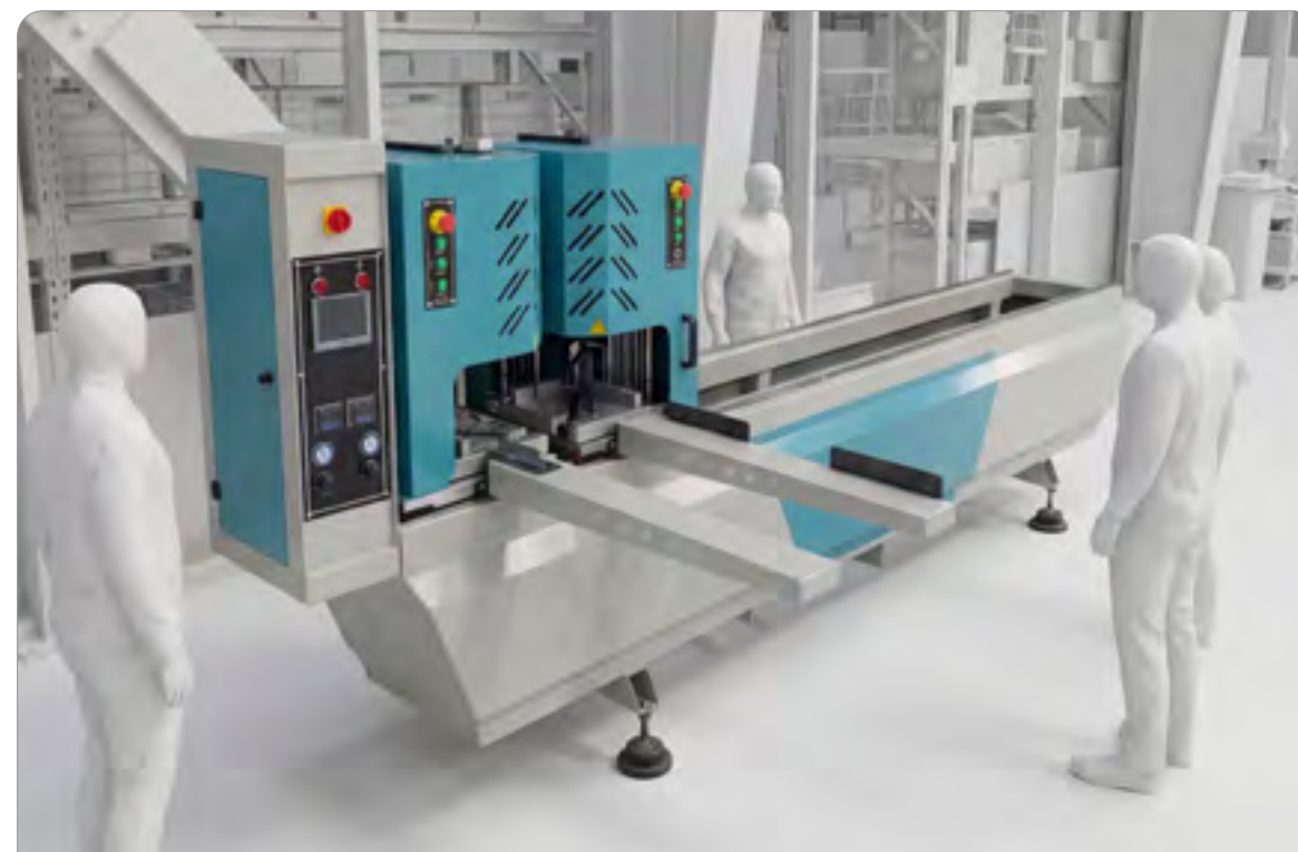
دستگاه جوش UPVC دوسر اتوماتیک AUTOMATIC TWO-HEAD UPVC MACHINE
