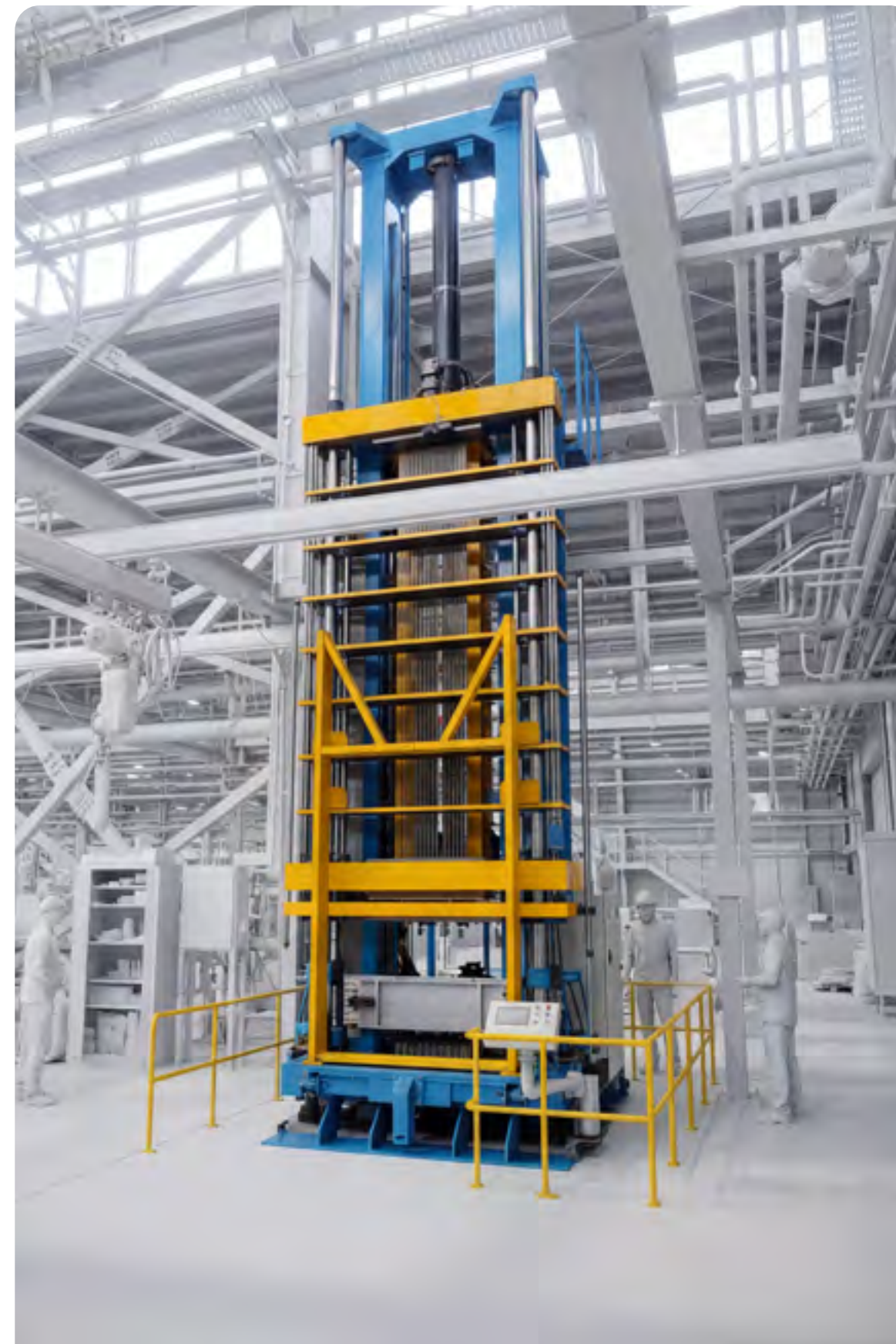
دستگاه اکسپندر عمودی ۳/۸ VERTICAL EXPANDER 3/8 MACHINE
