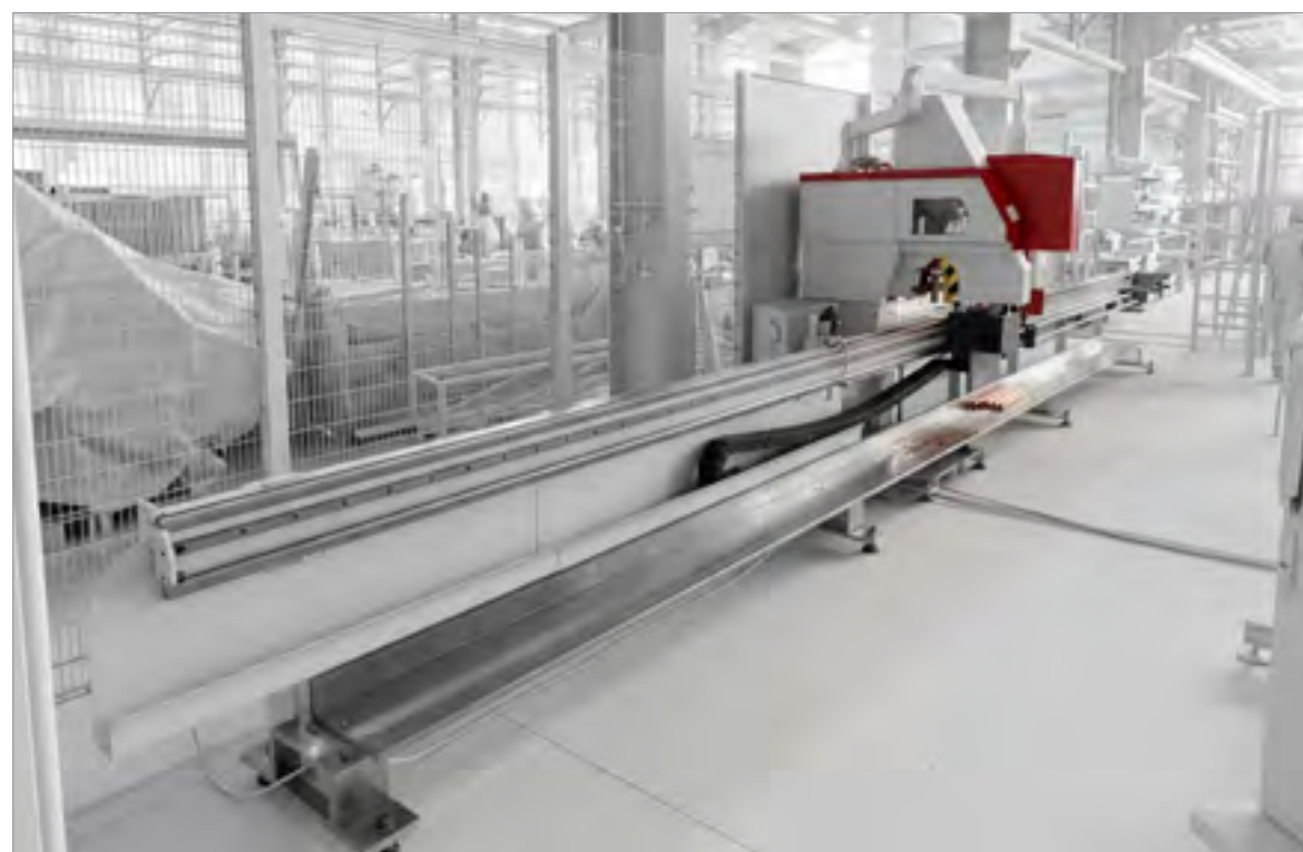
دستگاه لوله یقه‌کن PIPE FLANGING MACHINE
