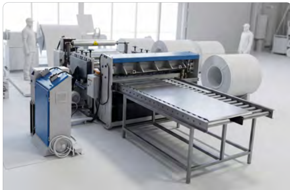
دستگاه برش ورق SHEET METAL CUTTING MACHINE
